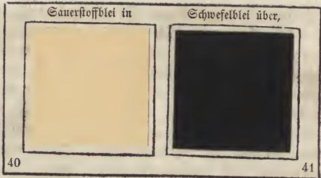
wenn es, mit Schwefel vermengt, in einem Tiegel erhitzt wird. Unter diesen Umständen ist nämlich die Anziehung des Bleies zum Schwefel größer als zum Sauerstoff, jener wird also aufgenommen und dieser entweicht. Da aber Schwefel und Sauerstoff sich leicht mit einander verbinden, so geschieht es auch hier, wo sie bei Glühitze zusammen kommen, und es entweicht kein reiner Sauerstoff, sondern Sauerstoffschwefel oder schweflige Säure.
